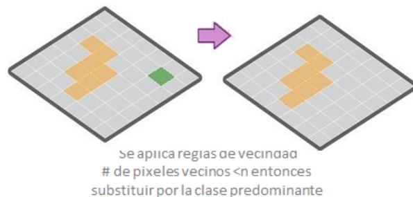
Figura 18. Esquema de la funcionalidad del filtro espacial.
